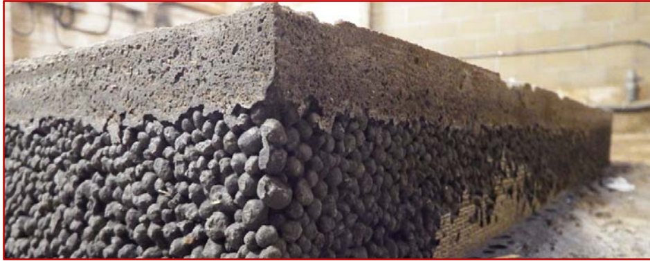
شكل رقم (5) خرسانة خالية من الركام الناعم مغطاة بخرسانة اعتيادية ( http://c8a.co.uk/applications/screed )
