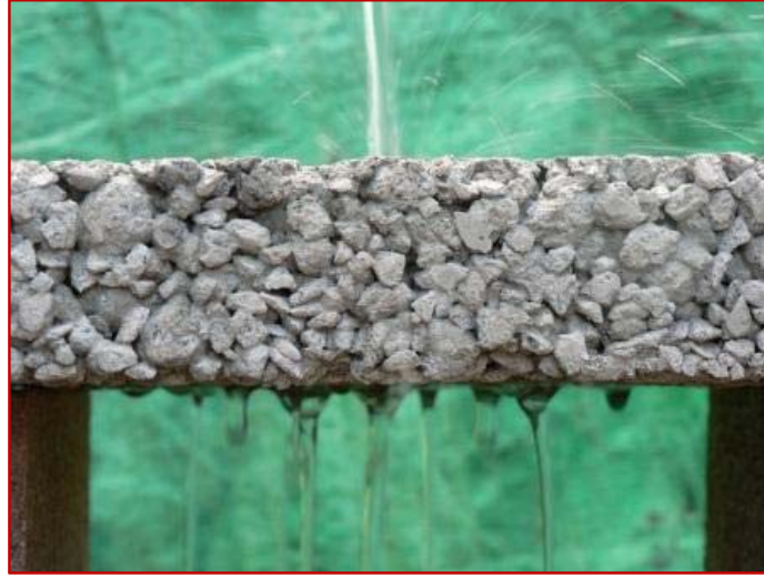
شكل رقم (6) خرسانة خالية من الرمل نفاذة للماء
